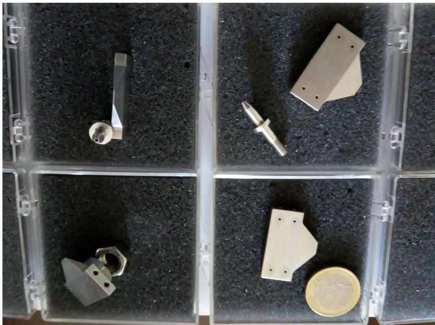
Figura 2.11: Fotografía de los electrodos de cuchilla y de aguja de la trampa.
